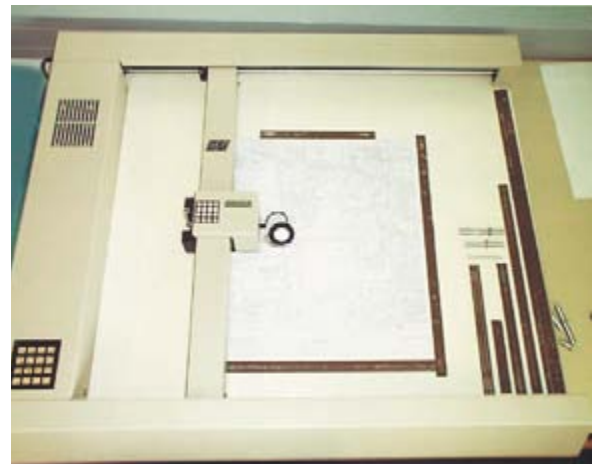
Neuerwerbung im Jahr 1987: Der Plotter „digiplot A1“. Er erlaubte erstmals, an Vermessungsämtern ganze Flurkarten zu plotten. Zusätzlich besaß er eine Digitalisiereinrichtung, die aber wegen der horizontalen Aufstellung und der Größe der Plotter ergonomisch nicht befriedigen konnte.
