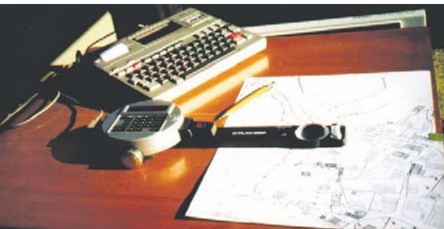
1990 wurde ein „mobiles Büro“, ausgestattet mit elektronischem Rollenplanimeter als Digitalisierereinrichtung und Plotter, getestet.
