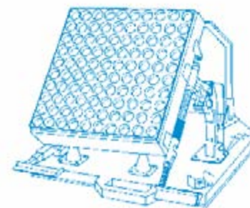
Laserreflektoren auf dem Mond
